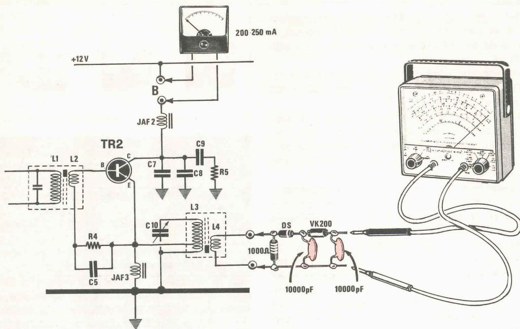
**Fig. 4** Per tarare in modo perfetto uno stadio amplificatore di AF si consiglia, oltre al milliamperometro posto in serie al collettore, di applicare ai capi della bobina L4 una semplice ma utile sonda di carico. Così facendo potremo controllare il funzionamento di tale stadio e vedere come un aumento della corrente di collettore non sempre corrisponde ad un aumento di energia AF in uscita, come spesso erroneamente si potrebbe supporre. Consigliamo,
