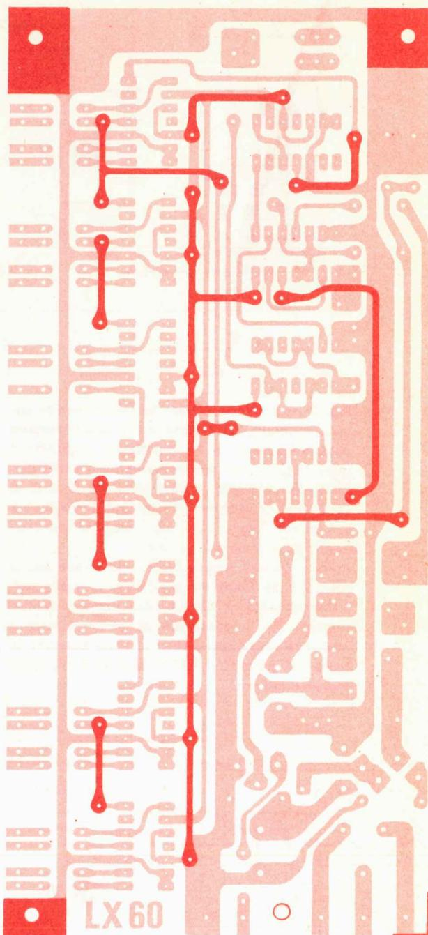
**Fig. 6** Circuito stampato a doppia faccia del contatempo digitale da noi denominato LX60. Facciamo presente al lettore che le piste di rame superiori andranno collegate con quelle inferiori tramite sottili fili di rame, stagnandoli da entrambe le parti. (vedi anche schema pratico).
