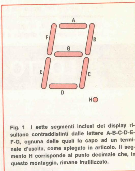
Fig. 1 I sette segmenti inclusi del display risultano contraddistinti dalle lettere A-B-C-D-E-F-G, ognuna delle quali fa capo ad un terminale d'uscita, come spiegato in articolo. Il segmento H corrisponde al punto decimale che, in questo montaggio, rimane inutilizzato.
