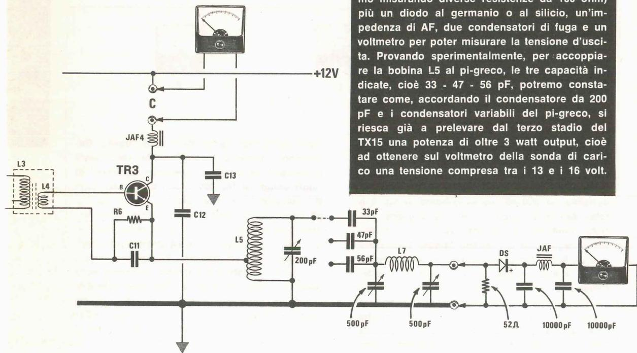
la sonda di carico, diminuendo la capacità fino a trovare la posizione dove lo strumento indichi la massima tensione. Si noterà così che troveremo un punto ben preciso dove la tensione da 5-8 volt bruscamente salirà verso i 17-19 volt;
