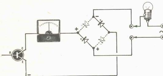
**Fig. 5** Infatti quando la corrente alternata invertirà la sua polarità, i due diodi precedenti che rimanevano inoperosi ora si portano in conduzione, collegando sempre al collettore la polarità positiva dell'onda alternata.
