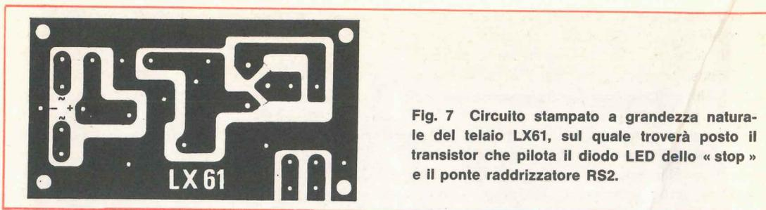
**Fig. 7** Circuito stampato a grandezza naturale del telaio LX61, sul quale troverà posto il transistor che pilota il diodo LED dello « stop » e il ponte raddrizzatore RS2.
