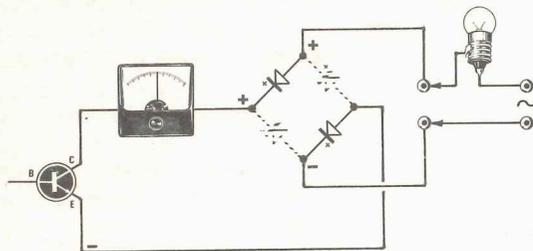
**Fig. 4** Questo reostato funziona anche per corrente alternata, il ponte raddrizzatore in questo caso risulta indispensabile per poter far giungere al collettore la semionda positiva, e all'emettitore sempre la semionda negativa.
