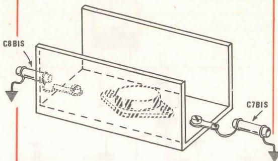
**Fig. 7** Se al transistor abbiamo applicato un'aletta di raffreddamento, risulta indispensabile, applicare alle due estremità di tale aletta altri due condensatori supplementari da 4.700 pF o da 1.000 pF. Perciò; se nel vostro montaggio sperimentale vi accadesse di constatare che un transistor autooscilla, provate ad applicare i due condensatori, come da noi consigliato, e tale inconveniente sarà eliminato all'istante.
