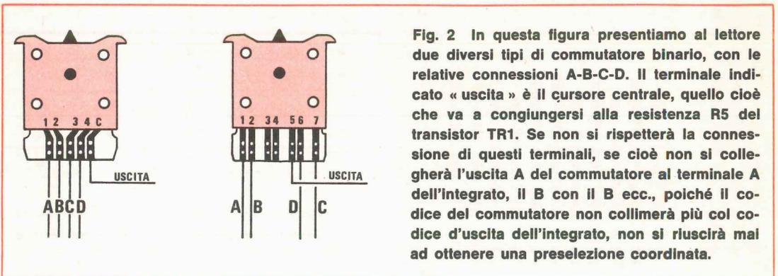
In altre parole, le uscite A-B-C-D di questi commutatori risulteranno decodificate esattamente come il codice di un divisore per 10 sopra presentato, con la differenza che quando in questa tavola della verità troviamo il numero « 1 » possiamo considerare tale terminale collegato elettricamente a quello « d'uscita », mentre quando nella tavola della verità troviamo il numero « 0 » tale terminale risulta elettricamente isolato.
