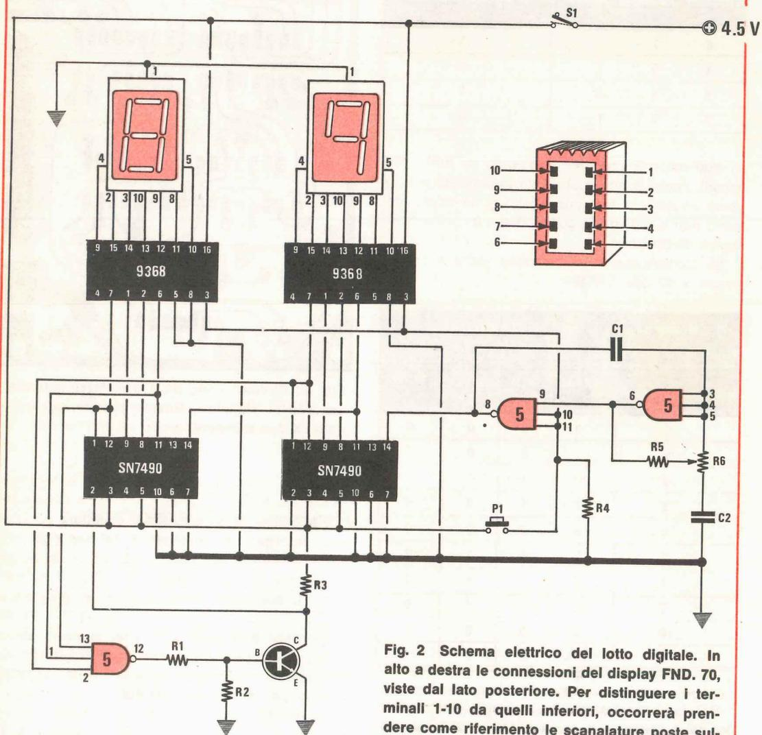
Fig. 2 Schema elettrico del lotto digitale. In alto a destra le connessioni del display FND. 70, viste dal lato posteriore. Per distinguere i terminali 1-10 da quelli inferiori, occorrerà prendere come riferimento le scanalature poste sull'estremo del corpo.
