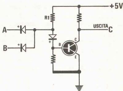
**Fig. 3** Il motivo per il quale i due terminali di entrata di una porta, se lasciati liberi, si trovino in condizione « 1 », lo possiamo comprendere facilmente guardando lo schema elettrico di una porta DTL. Come è possibile intuire, se le due entrate A-B non risultano collegate a massa, avremo sempre sulle uscite la tensione positiva del 5 volt di alimentazione, e i due diodi di uscita posti nel giusto senso di conduzione.
