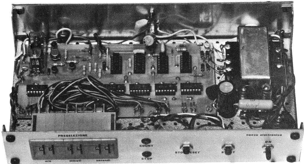
**Come si presenta a costruzione ultimata il contatempo digitale. In questo prototipo non sono stati utilizzati i «decimi di secondi» per cui i commutatori binari sono solo 6 anziché 7.**
