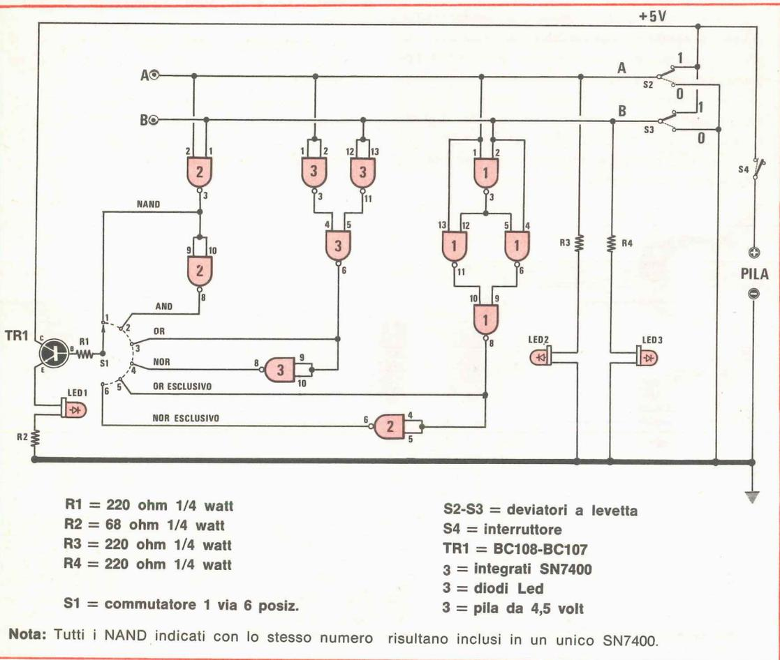
BC108, sul cui emettitore viene collegato un diodo LED.
